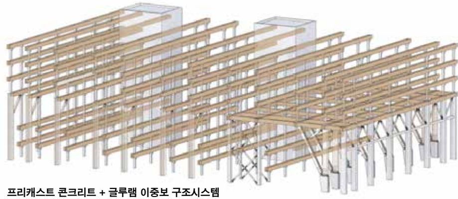
프리캐스트 콘크리트 + 글루램 이중보 구조시스템
